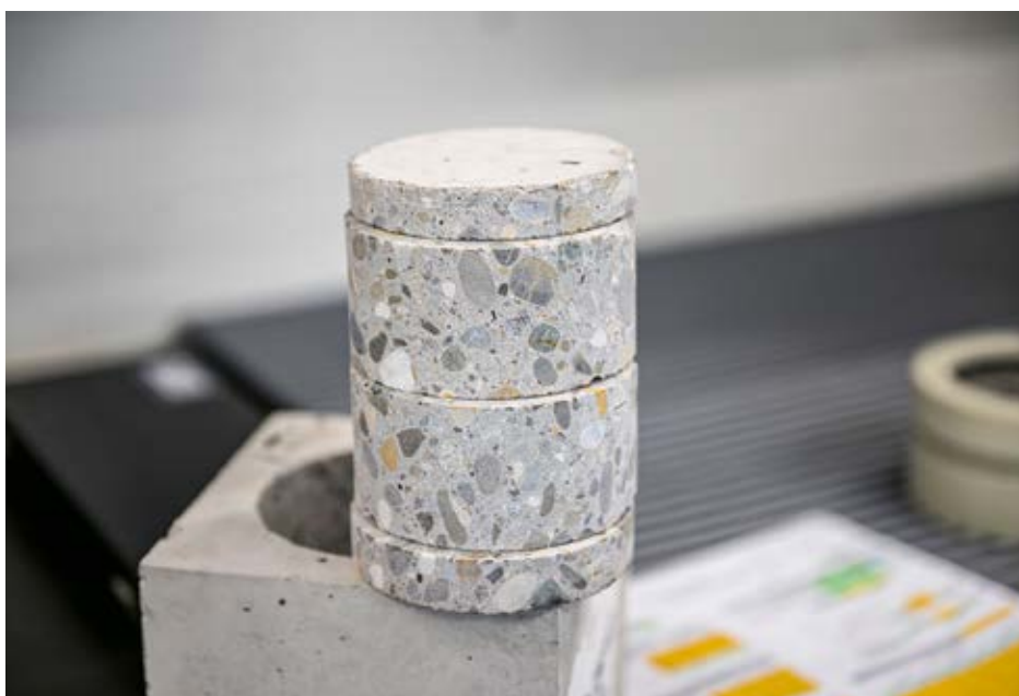
EIN PRÜFKÖRPER, BEVOR ER FÜR 24 STUNDEN INS KALIUM-HYDROXID-BAD KOMMT.
