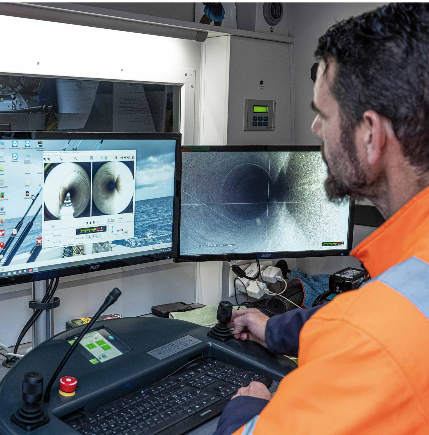
**Ultrahochauflösende Aufnahmen** erkennen auch kleinste Schäden und Risse in den Leitungen. Das bietet die besten Voraussetzungen für eine frühzeitige, präzise und kostensparende Sanierung.
