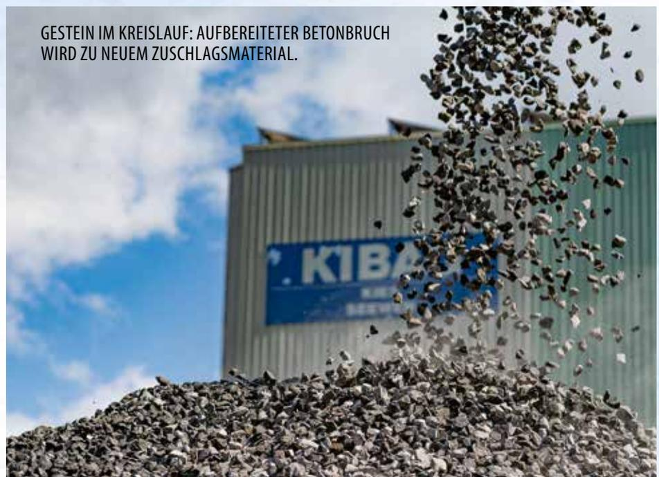
GESTEIN IM KREISLAUF: AUFBEREITETER BETONBRUCH WIRD ZU NEUEM ZUSCHLAGSMATERIAL.
