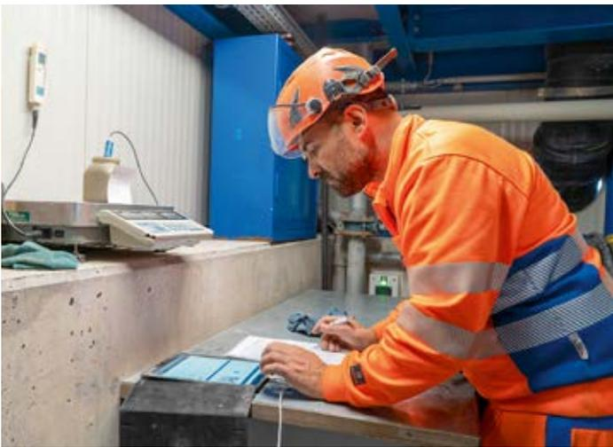
RAMADAN JUSUFI, LEITER KIESWERK UND SCHLAMMANNAHME, ÜBERPRÜFT DEN PH-WERT DES BOHRSCHLAMMS.
