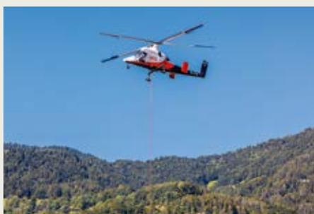
entre o edifício da nova fábrica e os carris da Rhätischen Bahn? De facto, não era possível colocar uma grua nem atrás do edifício nem sobre os carris. A solução foi um helicóptero. (p. 22-23)
