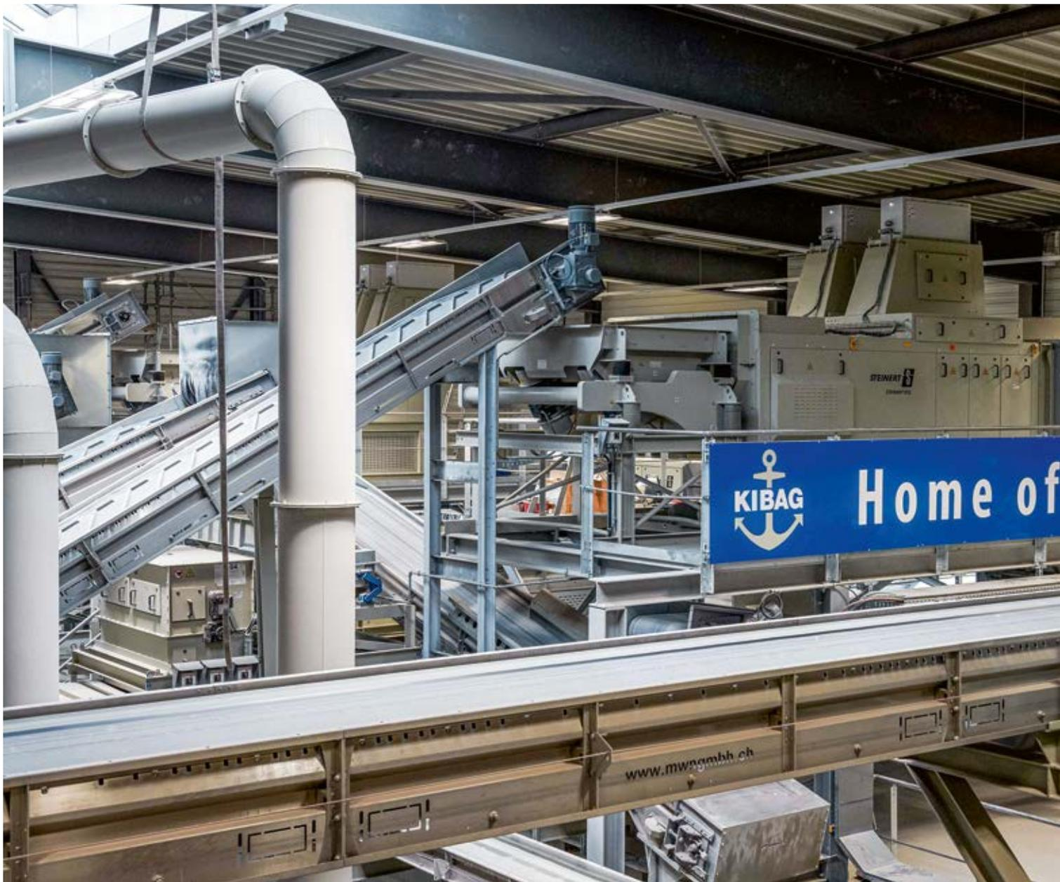
Die Sortag Zürich in Rümlang ist die modernste und innovativste Sortieranlage der Schweiz – wenn nicht sogar eine der modernsten Europas. Die Anlage sortiert vor allem Sperrgut, Bauschutt und Mischabbruch; mit einem Durchlauf von 25 bis 30 Tonnen pro Stunde erreicht sie eine Wiederverwertungsquote von weit über 90 Prozent. Noch, denn die Anlage lernt jeden Tag dazu. Und dadurch werden auch die Rezyklierquote und die Qualität des Materials von Tag zu Tag besser.
